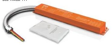
Le pilote de secours à LED de la série BLD-HMXXD-YYY est homologué UL pour les installations sur le terrain et en usine. Il passe en mode d'urgence en cas de panne de courant, fournissant jusqu'à 90 minutes d'éclairage. Avec une batterie, un chargeur et un convertisseur intégrés, il fournit une puissance constante de 6-25W à 170VDC. Il est idéal pour les luminaires LED d'intérieur à gradation 0-10V, tels que les panneaux plats, les troffers, les downlights et les bandes lumineuses linéaires.
