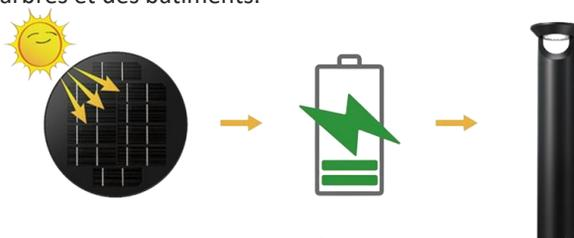
Il est disponible avec une activation automatique (contrôleur PWM) pour économiser de l'énergie et durer plus longtemps. Les heures de fonctionnement peuvent être divisées en mode intelligent à cinq niveaux, du crépuscule à l'aube, et l'intensité lumineuse peut être contrôlée. Le profil de fonctionnement peut être modifié à l'aide de la télécommande vendue séparément. Avec cette télécommande, elle peut fonctionner en continu pendant 3 à 4 jours avec 8 heures de temps de charge.
