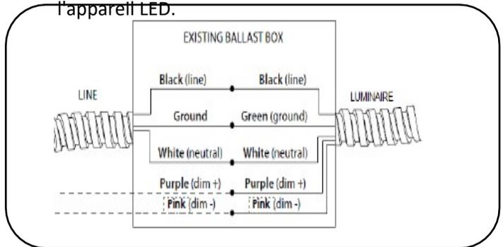
8 Connectez les fils de rétrofit à la boîte de jonction comme décrit : écrou de fil le sol (vert), écrou de fil l'entrée noire avec le fil noir du câble de MC, écrou de fil le fil d'entrée blanc avec le fil blanc du câble de MC, écrou de fil violet au violet , et gris à gris. Si les fils violets et gris ne sont pas utilisés, les plafonner avec des écrous.
