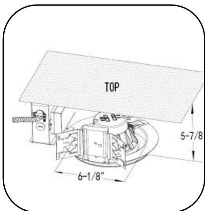
9 Placez le kit rétrofit dans le plafond en soulevant vers le haut sur les deux onglets de rétention. Effectuez cette étape avec soin, les onglets de rétention ont des ressorts et peuvent pincer la peau et causer des blessures. Poussez le luminaire jusqu'à ce qu'il soit rincé avec le plafond. . Restaurer l'électricité à l'unité pour terminer l'installation.
