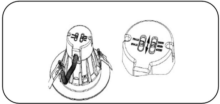
6 Sélectionnez le niveau de lumen désiré en l'utilisant l'interrupteur de commande sur le dessus de l'appareil LED.
