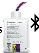
Il s'agit d'un bloc d'alimentation qui fournit une sortie 12V DC pour alimenter les capteurs et la commutation pour les pilotes de LED non-dim-to-off. Le PPA103S fournit également un fil de gradation 0-10V pour un contrôle de mouvement à deux niveaux et une sortie de relais.
