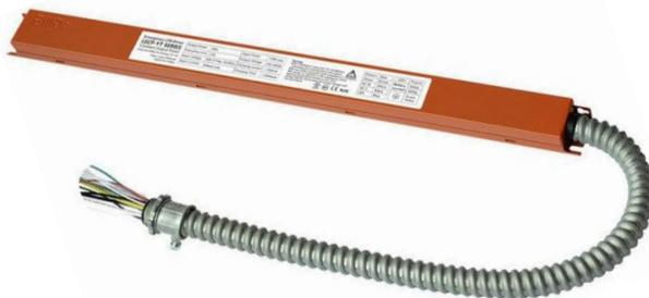
Le pilote de secours à LED de la série BLD-YTXXD-XXX est homologué UL pour les installations sur le terrain et en usine. Il passe en mode d'urgence en cas de panne de courant, fournissant jusqu'à 90 minutes d'éclairage. Avec une batterie, un chargeur et un convertisseur intégrés, il fournit une puissance constante de 8 ou 15 W à 30-60 VDC. Sa forme fine est idéale pour une utilisation dans les luminaires linéaires à LED.
