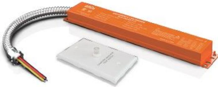
Le pilote de secours à LED de la série BLD-HMXXD-YYY est homologué UL pour les installations sur le terrain et en usine. Il passe en mode d'urgence en cas de panne de courant, fournissant jusqu'à 90 minutes d'éclairage. Avec une batterie, un chargeur et un convertisseur intégrés, il fournit une puissance constante de 6-25W à 170VDC. Il est idéal pour les luminaires LED d'intérieur à éradation 0-10V, tels que les panneaux plats, les troffers, les downlights et
