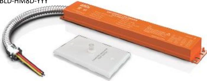
Le pilote de secours à LED de la série BLD-HMXXD-YYY est homologué UL pour les installations sur le terrain et en usine. Il passe en mode d'urgence en cas de panne de courant, fournissant jusqu'à 90 minutes d'éclairage. Avec une batterie, un chargeur et un convertisseur intégrés, il fournit une puissance constante de 6-25W à 170VDC. Il est idéal pour les luminaires LED d'intérieur à gradation 0-10V, tels que les panneaux plats, les troffers, les downlights et les bandes lumineuses linéaires.
