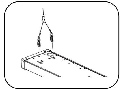
1 Fixation du crochet et suspension de l'appareil.
