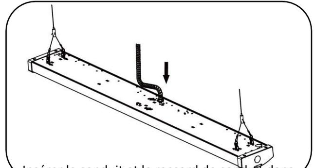
5 Insérer le conduit et le raccord de conduit dans le boîtier de la lampe.
