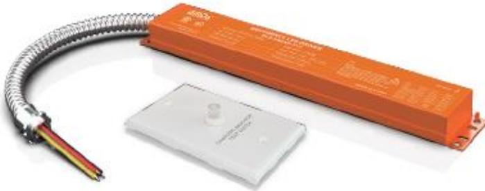
Le pilote de secours à LED de la série BLD-HMXXD-YYY est homologué UL pour les installations sur le terrain et en usine. Il passe en mode d'urgence en cas de panne de courant, fournissant jusqu'à 90 minutes d'éclairage. Avec une batterie, un chargeur et un convertisseur intégrés, il fournit une puissance constante de 6-25W à 170VDC. Il est idéal pour les luminaires LED d'intérieur à gradation 0-10V, tels que les panneaux plats, les troffers, les downlights et
