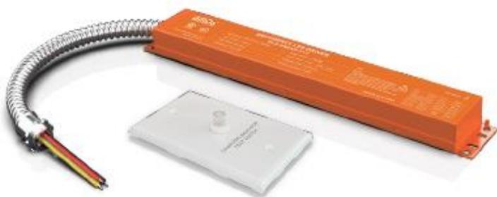
Le pilote de secours à LED de la série BLD-HMXXD-YYY est homologué UL pour les installations sur le terrain et en usine. Il passe en mode d'urgence en cas de panne de courant, fournissant jusqu'à 90 minutes d'éclairage. Avec une batterie, un chargeur et un convertisseur intégrés, il fournit une puissance constante de 6-25W à 170VDC. Il est idéal pour les luminaires LED d'intérieur à gradation 0-10V, tels que les panneaux plats, les troffers, les downlights et
