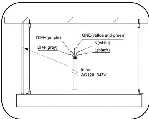
12 Retirer le couvercle du conducteur et terminer le câblage en suivant le diagramme. Le cas échéant, sélectionner le CCT désiré.
