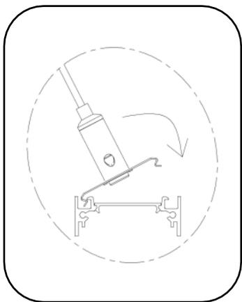
10 Installer le support du câble de suspension aux deux extrémités de l'appareil comme indiqué ci-dessus.
