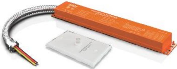
La commande d'urgence à LED de la série BLD-HMXXD-YYY est homologuée UL pour les installations sur site et en usine. Il passe en mode d'urgence en cas de panne de courant, fournissant jusqu'à 90 minutes d'éclairage. Avec une batterie, un chargeur et un convertisseur intégrés, il délivre une puissance constante de 6-25W à 170VDC. Idéal pour les luminaires à LED d'intérieur à gradation 0-10V, tels que les panneaux plats, les troffers, les downlights et les bandes lumineuses linéaires.
