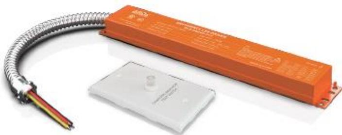
Le pilote de secours à LED de la série BLD-HMXXD-YYY est homologué UL pour les installations sur le terrain et en usine. Il passe en mode d'urgence en cas de panne de courant, fournissant jusqu'à 90 minutes d'éclairage. Avec une batterie, un chargeur et un convertisseur intégré, il fournit une puissance constante de 6-25W à 170VDC. Il est idéal pour les luminaires LED d'intérieur à gradation 0-10V, tels que les panneaux plats, les troffers, les downlights et
