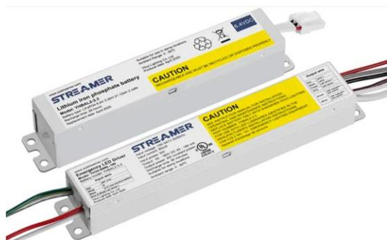
Cet interrupteur d'urgence à LED de Streamer est homologué UL et installé en usine. Il passe en mode d'urgence en cas de panne de courant et fournit jusqu'à 90 minutes d'éclairage. Avec une batterie, un chargeur et un convertisseur intégrés, il délivre une puissance constante de 8W à 50-180VDC. Sa forme fine est idéale pour une utilisation dans les luminaires linéaires.
